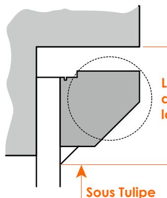
Le diamètre d'encombrement du tablier enroulé dépend de la hauteur du volet
