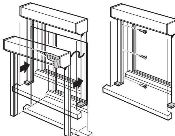
Percer avec un foret de  $\varnothing 6$  mm
