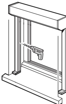
Percer avec un foret de  $\varnothing 6$  mm.
