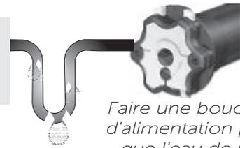
Faire une boucle sur le fil d'alimentation pour éviter que l'eau de pluie ne s'infilte dans la tête moteur.
