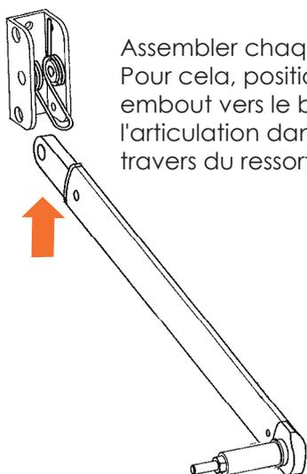
Assembler chaque articulation de bras. Pour cela, positionner le bras verticalement, embout vers le bas, et mettre en place l'articulation dans la chape de bras au travers du ressort
