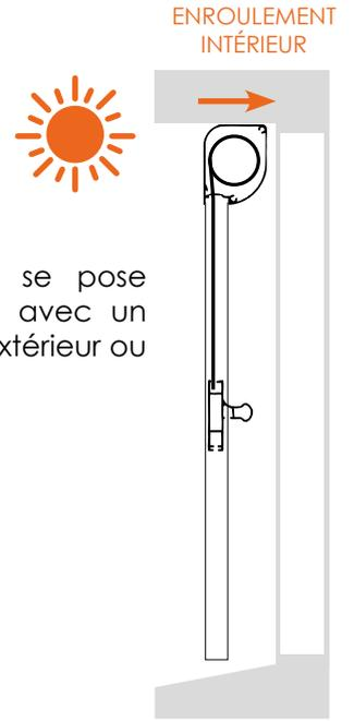
Cette moustiquaire se pose proche de la vitre, avec un enroulement vers l'extérieur ou vers l'intérieur.
