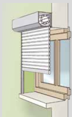
Pose en façade
