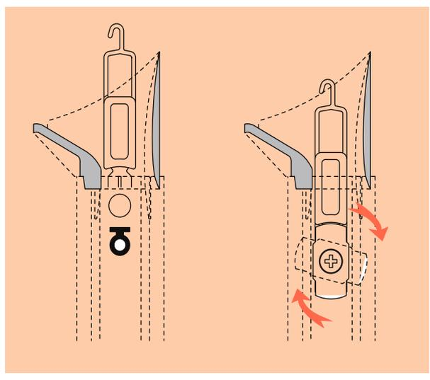
Montées en bout de la lame finale, les butées basses viennent arrêter le volet sous la tulipe.
