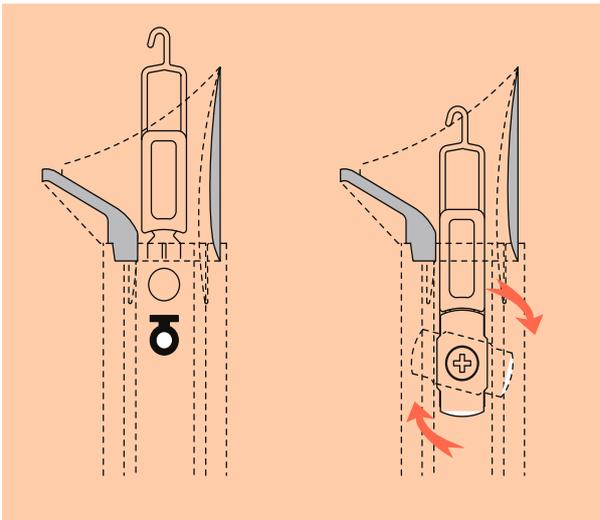
Montées en bout de la lame finale, les butées basses viennent arrêter le volet sous la tulipe.
