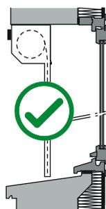
Le caisson doit être au plus près du mur extérieur
