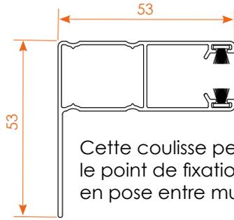
Cette coulisse permet d'éloigner le point de fixation de l'angle du mur, en pose entre murs.
