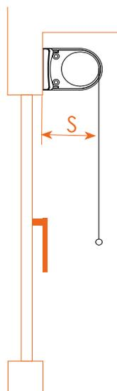
En pose de face, la poignée de la fenêtre ne doit pas gêner la descente du store.
