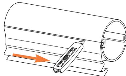
Pour démonter le lambrequin (bandeau de toile qui pend au bout du store), enlevez les embouts, dévissez les vis d'extrémité et faites-le coulisser.
