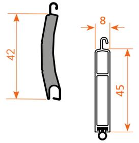
Lame finale droite avec joint d'étanchéité.
