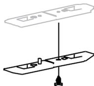
Il est possible de régler la position des verrous en déplaçant la poignée verticalement sur son support. Pour cela, desserrer la vis sur la poignée.
