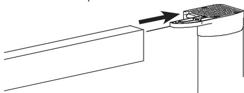
Engager la coulisse **courte** dans le boîtier du bas, et l'insérer dans le profil de fermeture.
