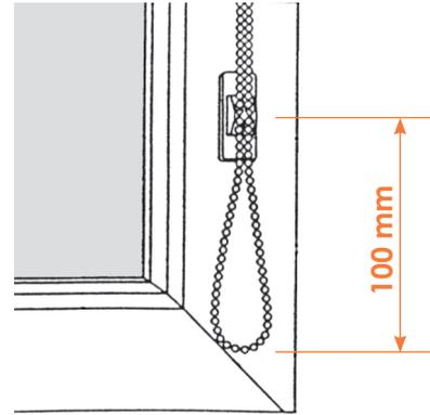
Fixer le bloqueur de chaînette sur le chassis du battant ou sur la parclose à l'aide de 2 vis.
