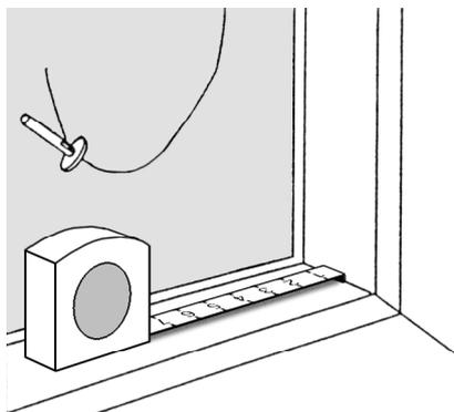
Percer un trou de  $\varnothing$  2,5 mm dans la parclose
