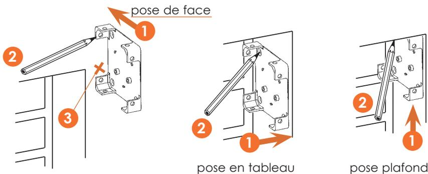
Percer les trous de fixation repérés sur les murs ainsi que le trou pour le passage du renvoi intérieur.
