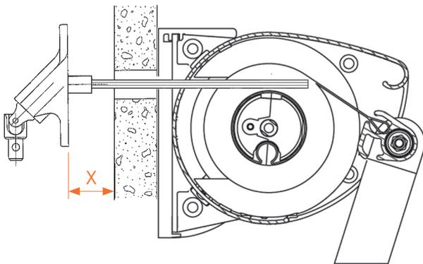
Présenter l'axe 6 pans du renvoi de manœuvre et l'engager dans le treuil sur une longueur de 50 mm environ
