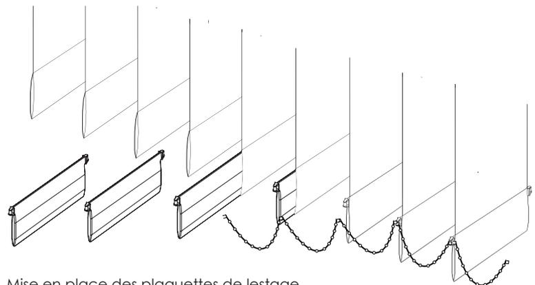
Mise en place des plaquettes de lestage et clippage des chaînettes de bas de bande.
