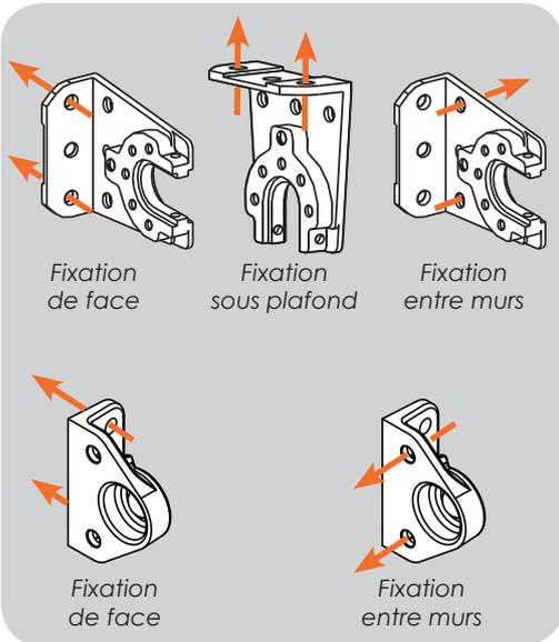
Fixation du pivot de bras : de face, sous plafond ou entre murs.
