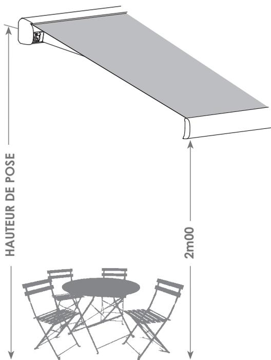
Hauteur de pose minimum pour une hauteur de passage de 2m00 sous la barre de charge.
