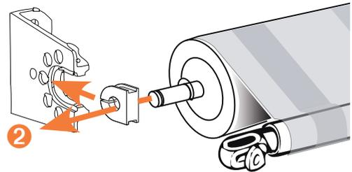
3 Monter la goupille et l'arrêt d'axe pour verrouiller.
