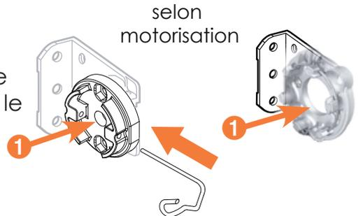
2 Côté opposé à la manœuvre, positionner l'embout télescopique dans le palier puis dans la fente du support
