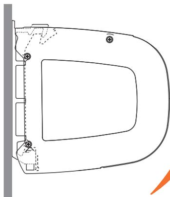
**3** Basculer le coffre de manière à le plaquer sur les supports de pose.
