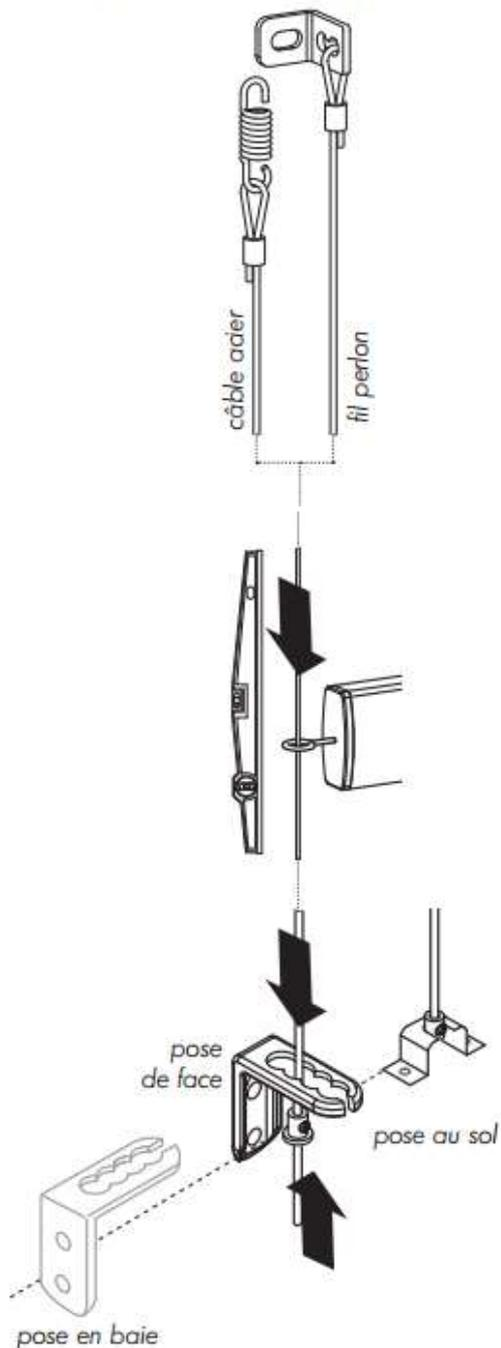
Passer les conducteurs dans les embouts de barre de charge.
