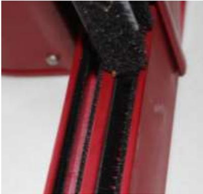
Coulisses doubles à gorges séparées : pour le volet et la moustiquaire. En aluminium extrudé, avec joints anti-bruit, les coulisses sont pré-perçées (diamètre perçage différent pour arrêter la tête de vis) de face ou par le fond au choix selon votre disposition.
