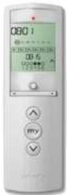
La TELIS 6 CHRONIS à canaux multiples est dotée d'une fonction horloge. Avec le choix du mode manuel ou automatique, son afficheur vous permet d'utiliser jusqu' à six produits Somfy RTS connectés individuellement ou en groupe par simple clic sur un bouton. La fonction horloge vous permet de configurer jusqu' à six ordres par jour pour un fonctionnement sans tracas et facilite la simulation de présence afin de prévenir tout intrus potentiel lorsque vous êtes loin de chez vous.
