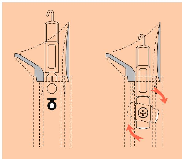
Montées en bout de la lame finale, les butées basses viennent arrêter le volet sous la tulipe. Réglage : Faire pivoter les butées à 90° à l'aide d'un tourne-vis.
