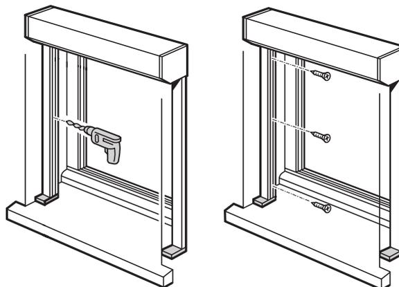
Percer avec un foret de  $\varnothing 6$  mm.
