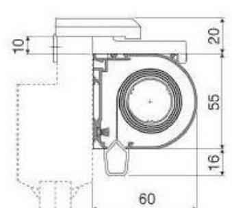
Pose avec fixations sans perçage
