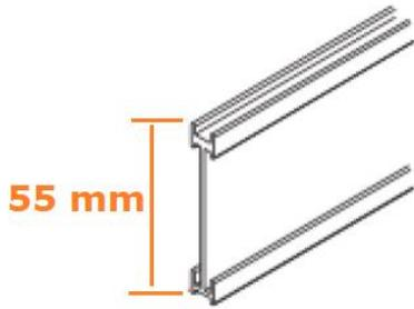
Un profil arrière, en aluminium extrudé laqué, soutient le mécanisme déjà monté. Il se fixe sur les clips inox préalablement installés. Pas besoin de percer au millimètre les trous des clips.
