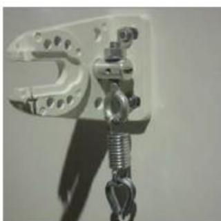
**5-2** Fixer l'équerre de guidage dans l'alignement vertical du «crochet ressort».
